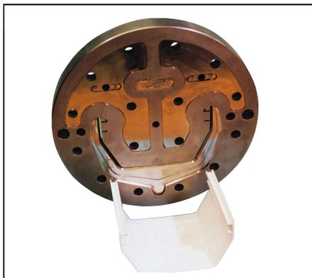
Corrax 用於生產 PVC 管。生產 PVC 管或設備的地方非常高的抗腐蝕性需求抵抗擠壓模具。
